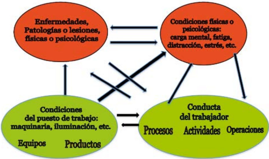
Figura 12. Interacciones entre los componentes del sistema de trabajo en relación a la seguridad operacional
